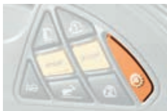
Activation aisée de l'automatisme QUADRACTIV sur le panneau de commande
