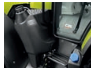
Tubulures de remplissage pour le réservoir d'urée de 17 l ou 23 l et le réservoir de carburant de 142 l ou 196 l du côté gauche.
