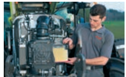
Retrait aisé du filtre à air moteur devant les radiateurs.
