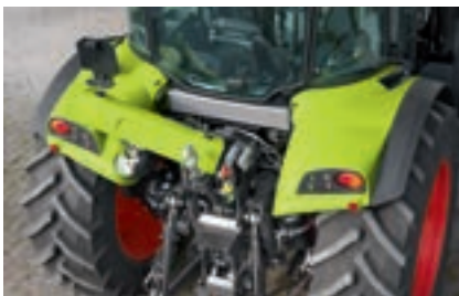
Accès aisé au filtre à air de cabine derrière la cabine.
