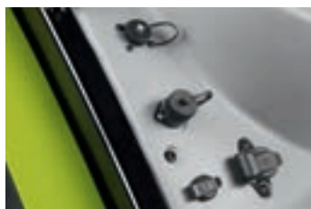
Connexions ISOBUS dans la cabine et à l'arrière
