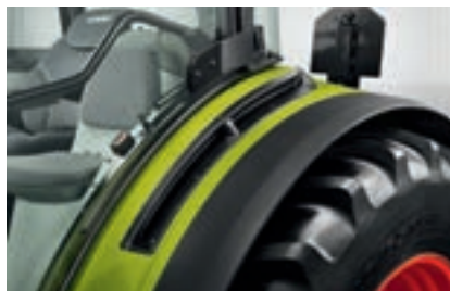
L'aspiration latérale de l'air de la cabine au niveau des ailes arrière permet un air sans poussière et des intervalles de maintenance espacés pour le filtre.
